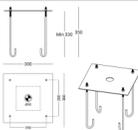
**KIT.002** Bodenverankerungssystem mit Holzbolzen und Zentrierplatte
